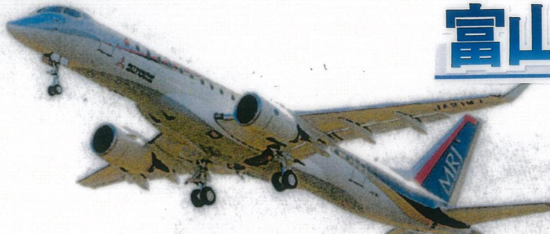
石金精機は、MRJの揚力を増大させる「高揚力装置」を動かす「レール」を手掛けた。同社によると、高揚力装置は離着陸時など必要に応じて主翼から作動するため、通常の部品に比べて動きが激しい。レールの摩耗も激しくなり、航空機で通常使われる軽量なアルミニウムではなく、鉄を使用した。
