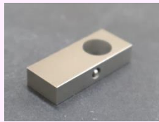
Diebase(杵に相当) 圧縮特性評価装置用金型
